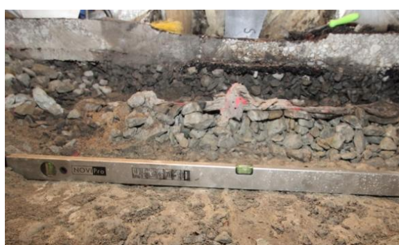
Joonis 13 – Pärast katset heas seisukorras graniidist killustikalus
