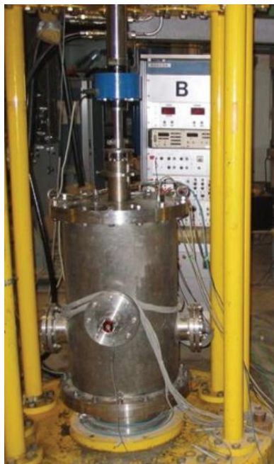
Joonis 17 - Kolmetelgse tsüklilise surveteimi katseseade
